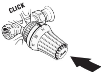
Для демонтажа необходимо повернуть кольцо у основания термоэлемента и снять изделие.
