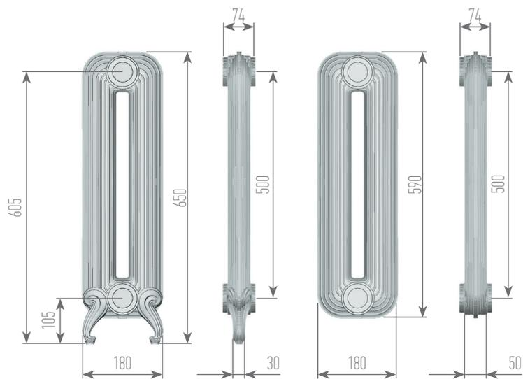
Размеры радиатора указаны без учета установленной арматуры и воздухоотводного клапана
